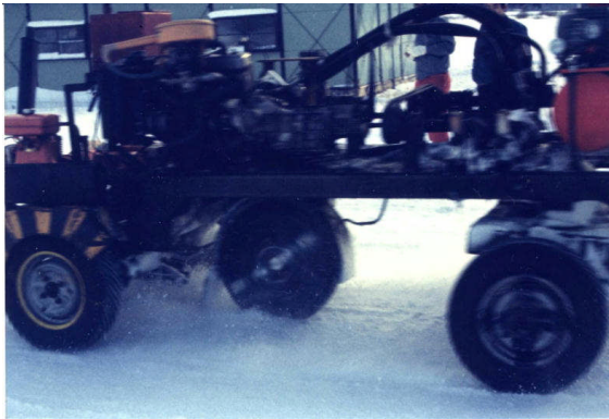
タイヤの摩擦試験 (中央が試験タイヤ)
