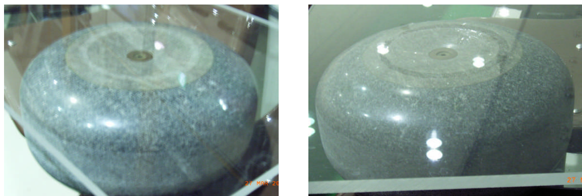
図 149 左：ストーンの底面に載せた透明板通してみたランニングバンド（帯状の白い輪） 右：底面を霧吹きで濡らすと左の白い帯は透明に変わる
