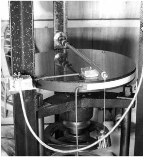
図 66 真の接触面の観察法(藤岡, 1962)
