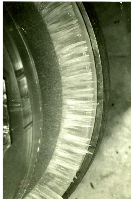
図 120 左: 回転円盤(氷)ーリング摩擦装置と右摩擦融解で生じたつらら
