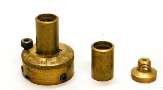
図 93 半球状氷滑走体試料(スライダ)ホルダー 左端のホルダーは氷の結晶面を回転できる
